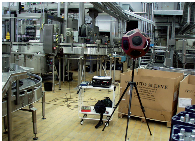
Bild 2 In einer Abfüllanlage aufgestellte Schallquelle zur Messung der Schallausbreitung.
