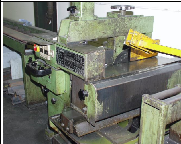
Anh.1, Abb. 65: Kreissäge LPC
