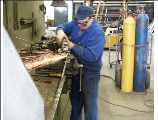
Anh.1, Abb. 64: Schruppschleifen
