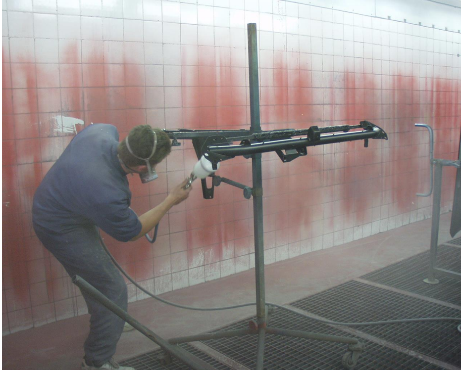
Anh.1, Abb. 25: Spritzlackieren in der Lackierkabine
