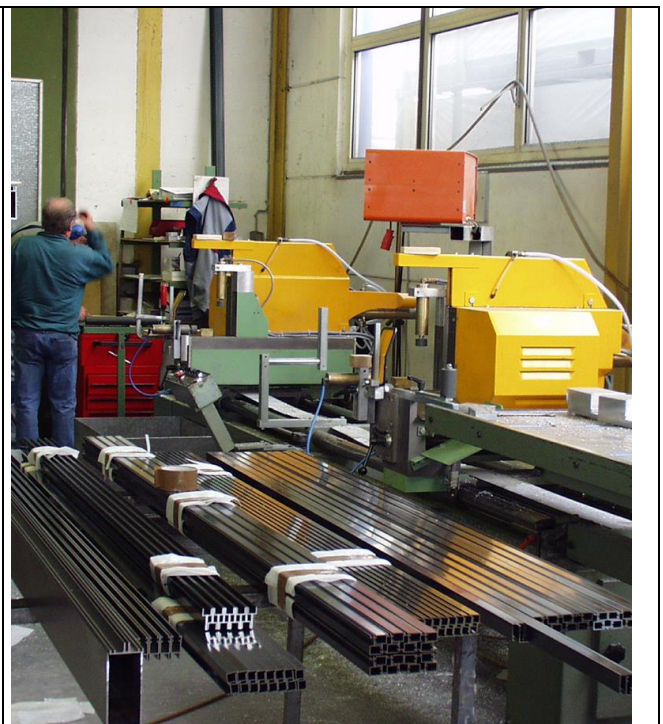
Anh.1, Abb. 35: Profilsäge RAPID
