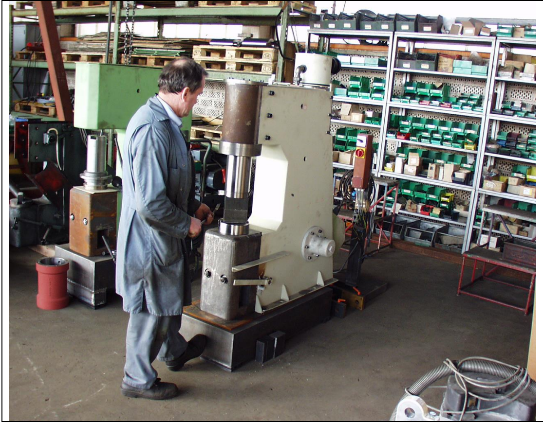
Anh.1, Abb. 10: Mechanische Werkstatt mit Schmiedehammer
