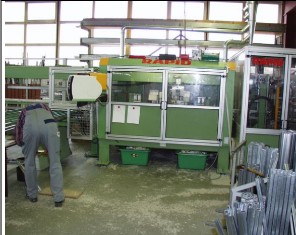
Anh.1, Abb. 38: Profilverarbeitungszentrum RAPID
