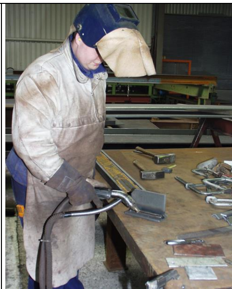
Anh.1, Abb. 50: Schutzgasschweißen
