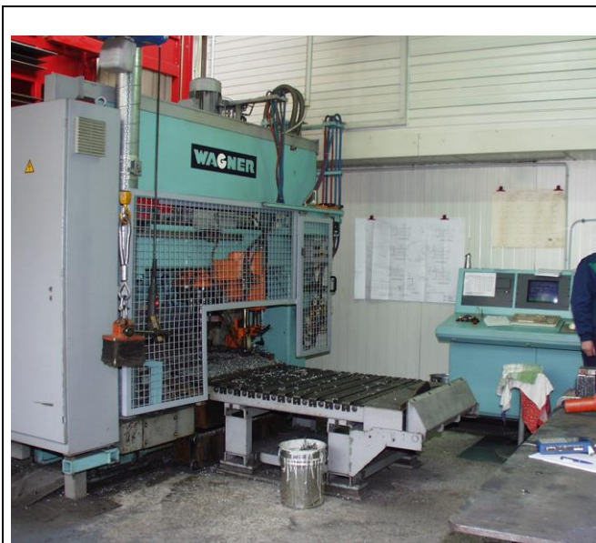
Anh.1, Abb. 49: Bohr-Brennanlage
