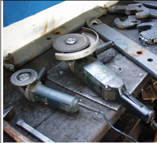
Anh.1, Abb. 30: Maschinen zum Schruppen
