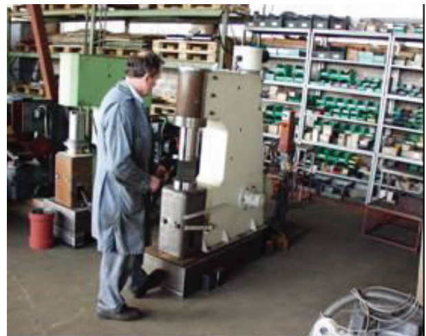
Abbildung 1: Kleine Schmiedemaschine in einer Werkstatt Damit kann eine Werkstatt mit 4 Stanzen und den entsprechenden Arbeitsplätzen entsprechend Abbildung 2 auf sehr einfache Weise modelliert werden.
