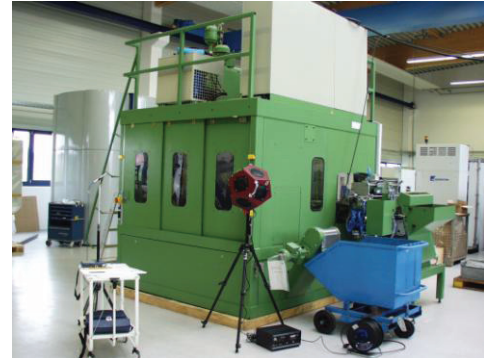
Abbildung 6: Gekapselte Maschine mit 3 Abstrahlbereichen
